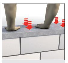
Das Verkleben der Bauteile untereinander muss nach spätestens 30 Minuten erfolgt sein. Immens wichtig ist ein ausreichender, kräftiger und flächiger Anpressdruck, beispielsweise durch das Aufstützen auf der Abkantung.
