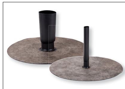
Die **Kebufix Dichtmanschette** ist ein Anschlussformteil mit einem Flansch aus Spezial-Polymerbitumen (PYE). Der Polyesterkombiträger vom Typ KTP verleiht dem Bitumendichtkragen eine extrem hohe mechanische Festigkeit. Bei dieser einteiligen Manschette ist der Schrumpfschlauch für eine einfache und sichere Verarbeitung bereits fest mit dem Kunststoffkörper verbunden. Der witterungsbeständige Schrumpfschlauch benötigt keine weitere mechanische Sicherung oder Versiegelung.
